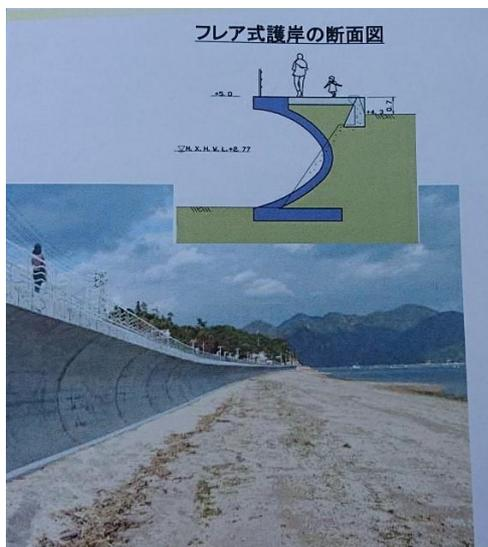
国道 2 号大野地区丸石～大竹市玖波までの越波対策について～過去に他の議員も質問されましたが、井上さちこも 2021(令和 3)年 12 月に一般質問しました。1999(平成11)年から 2020(令和 2)年までに、台風による高潮と越波の影響で、通行止めが6回発生しています。今年 3 月に市の交渉が実り、国土交通省中国整備局では、越波対策を発表しました。丸石～玖波間2.2kmを整備します。内容は「フレア式護岸」という方式です。この方式ですと、普段は散歩道として活用できます。
